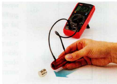
Ryc. 19.2. Wzbudzenie prądu w zwojnicy zbliżającej się do magnesu
