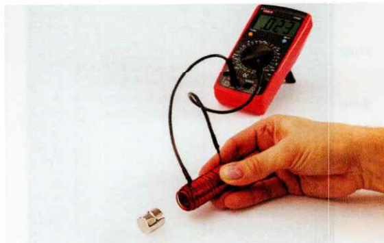
Ryc. 21.5. a) Powstawanie prądu indukcyjnego w zwojnicy podczas zbliżania magnesu. b) Hamowanie spadającego magnesu w miedzianej rurce
